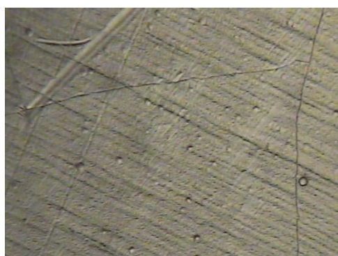
Рисунок 2. Поверхность КГП на основе хрома: а – без нанодисперсных частиц; б – с нанодисперсными частицами (x220)
