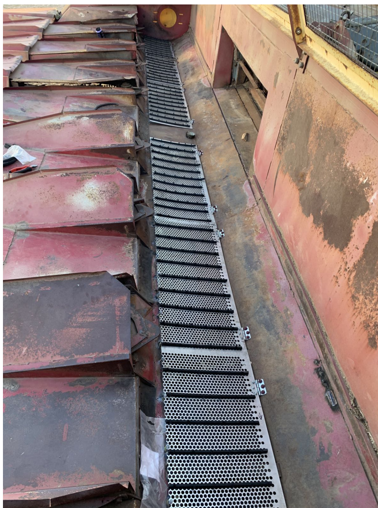
Рисунок 11. Экспериментальный адаптер с устройством предварительного обмолота корзинок, сепарацией и транспортировкой маслосемян на стрясную доску грохота
