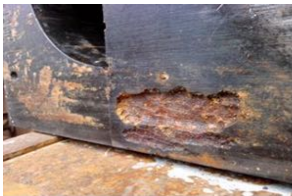
а) всасывающий поршень б) корпус камеры всасывания Рисунок 1 – Коррозия на поверхностях деталей тестоделительных машин
