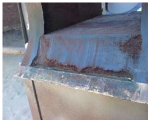
а) всасывающий поршень б) корпус камеры всасывания Рисунок 1 – Коррозия на поверхностях деталей тестоделительных машин
