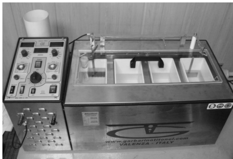
Рисунок 1. Лабораторная гальваническая установка
