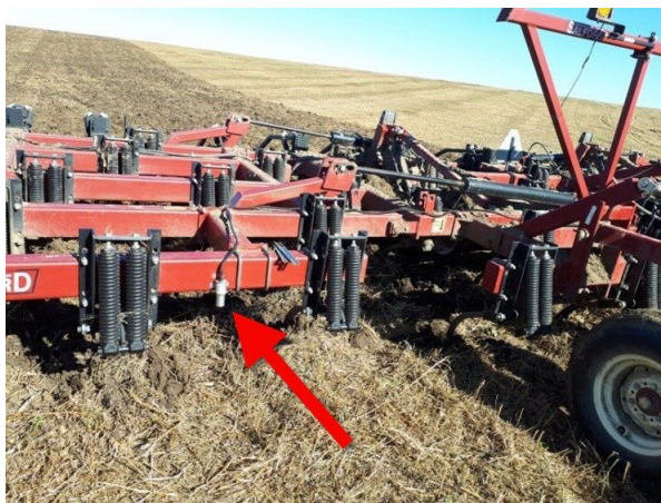
Рисунок 1. Ультразвуковой датчик глубины обработки почвы
