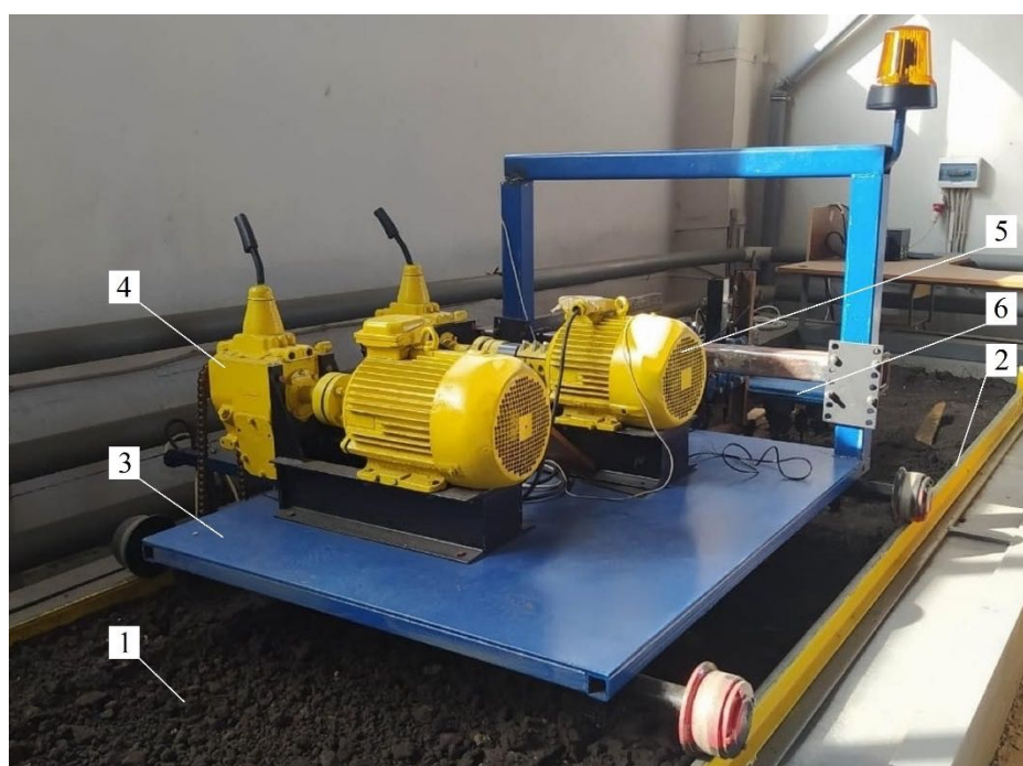
Рисунок 1. Общий вид экспериментального стенда для исследования рабочих органов почвообрабатывающих машин: 1 – почвенный канал; 2 – рельсовый путь; 3 – подвижный модуль; 4 – привод перемещения подвижного модуля; 5 – привод испытуемых активных рабочих органов; 6 – испытуемые активные рабочие органы
